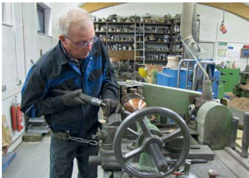
Christoph Müller di bengkelnya. Pada awal proses produksi, piala-piala itu berwarna merah-oranye yang terang karena tembaga yang digunakan
