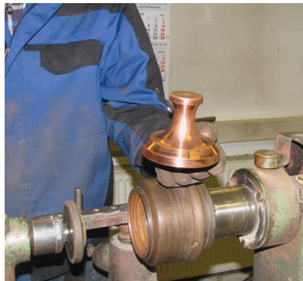
En el taller del forjador de metales. Como el Primer Pastor e.d. Müller utiliza cobre para hacer sus cálices, en la fase de producción primeramente son rojos
