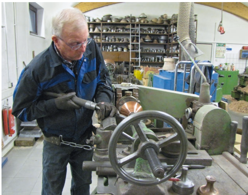
En el taller del forjador de metales. Como el Primer Pastor e.d. Müller utiliza cobre para hacer sus cálices, en la fase de producción primeramente son rojos
